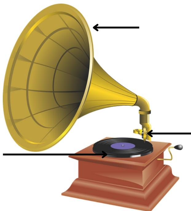
A) **Un plateau tournant** : le disque est déposé dessus et il tourne grâce à une manivelle.
